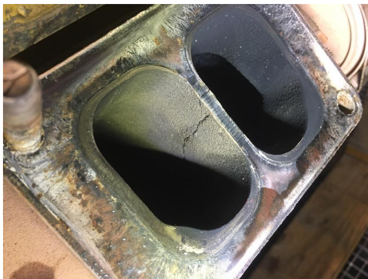
Рисунок 6 – Трещина на выпускном коллекторе
