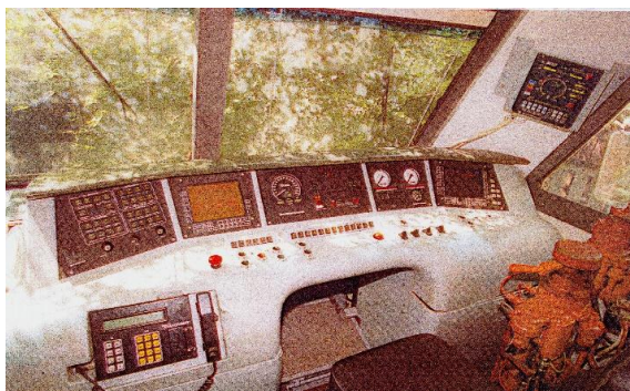
Рисунок 1 – Размещение оборудования в кабине локомотива
