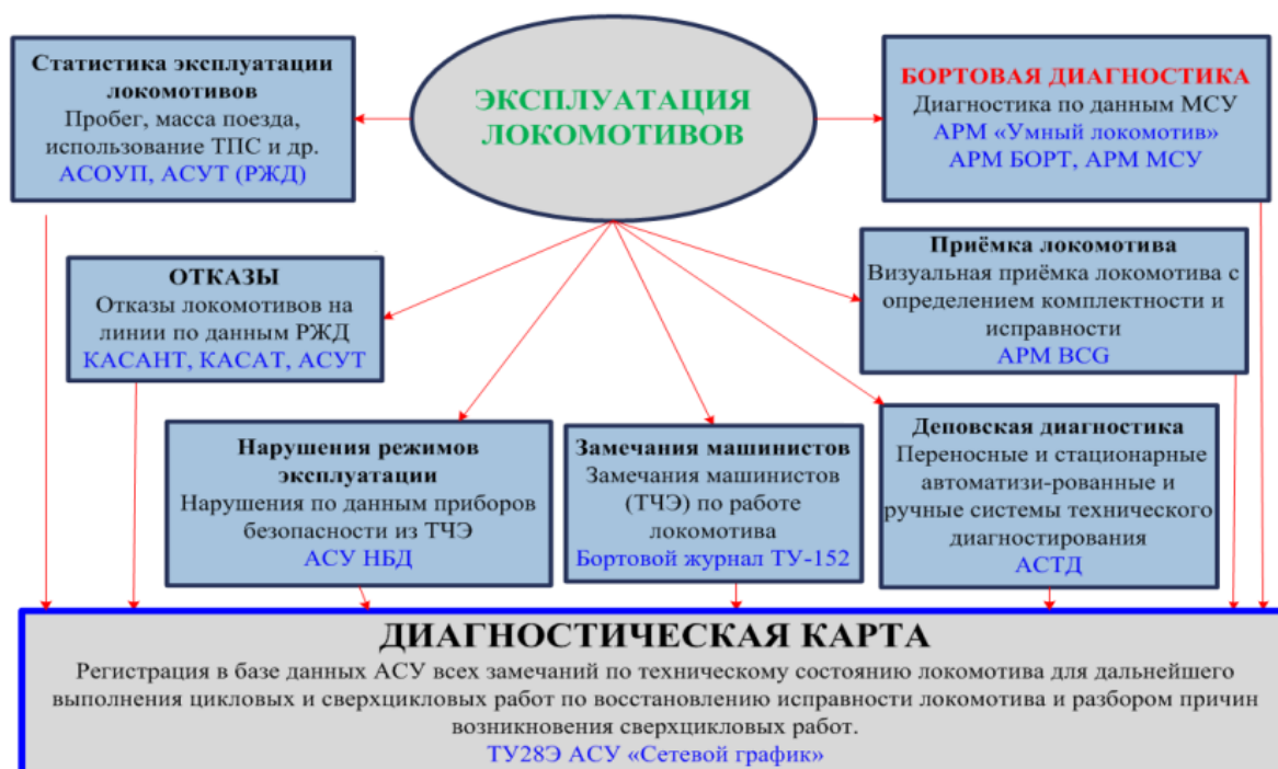
Рисунок 2 – Источники информации о техническом состоянии локомотивов
