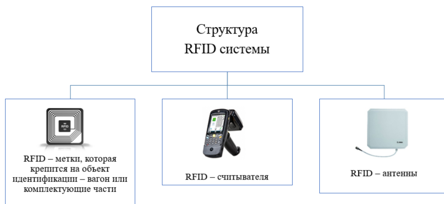
Рисунок 1– Структура RFID системы
