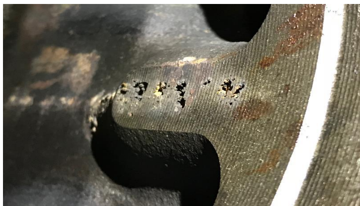
Рисунок 4 – Кавитационное разрушение блока в отливке под болт ГБЦ
