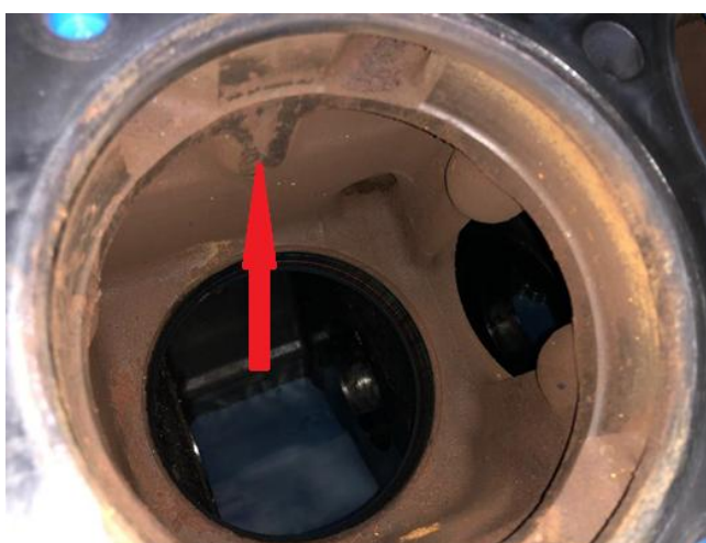
Рисунок 3 – Отливка под болт в блоке цилиндров
