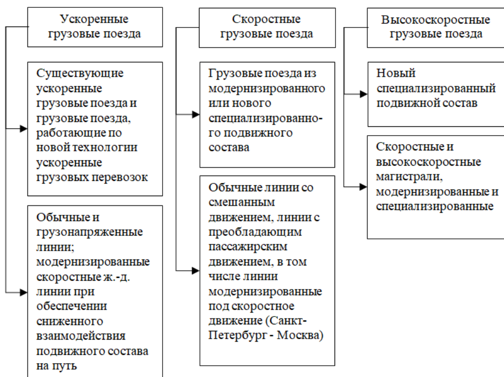
Рисунок 1 – Классификация грузовых поездов повышенной скорости и соответствующей инфраструктуры железнодорожных линий
