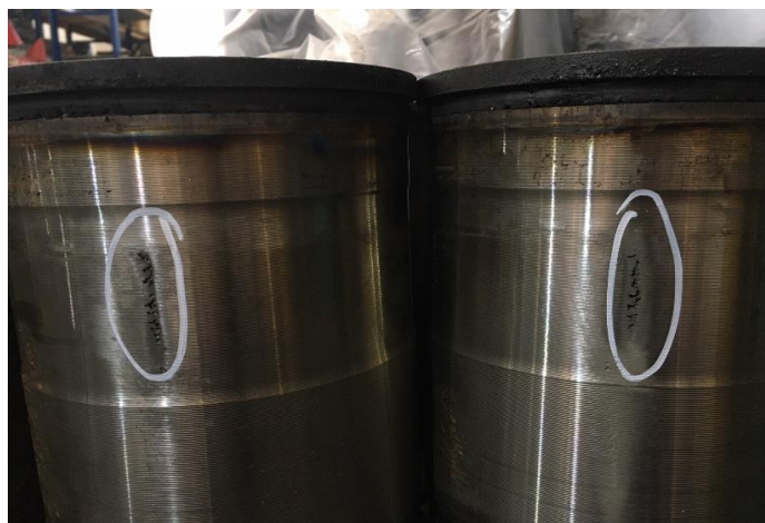
Рисунок 2 – Кавитация на гильзах
