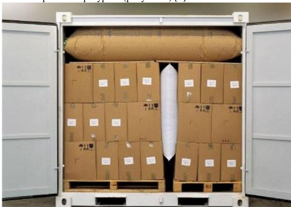
Рисунок 2 – Пример применения пневмооболочек
