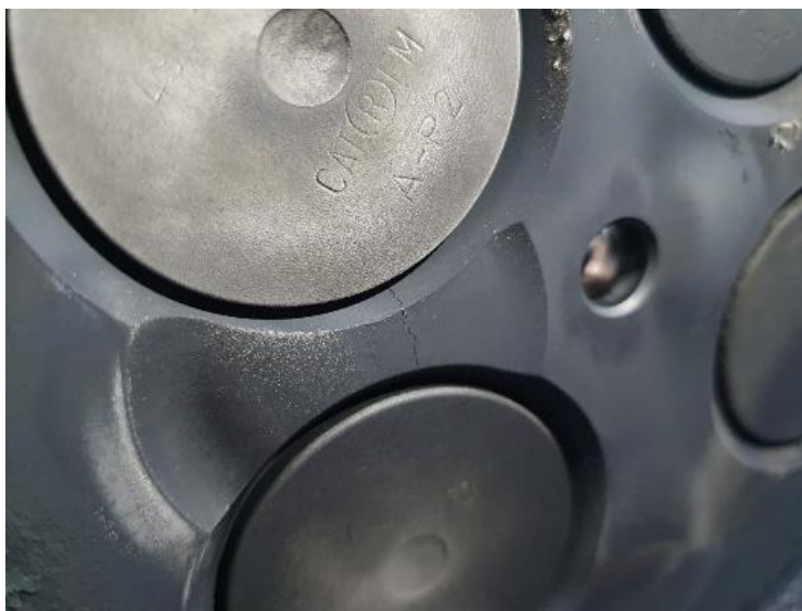
Рисунок 1 – Типовая трещина на ГБЦ
